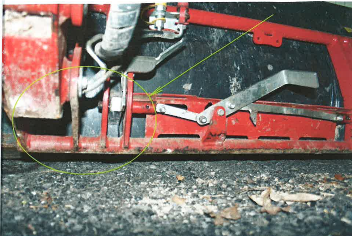
5. Pohled na spodni trubku nosniku s čepy pro ovládací prvky, kdy trubka je vyhnutá, čepy vyosené..jpg 09.07.2020 13:19
