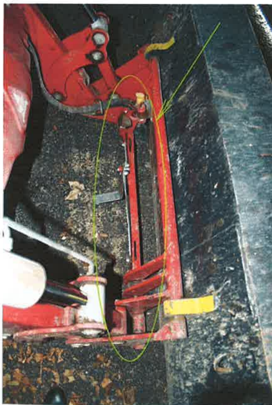
4. Pohled na trubky nosíku nakládací lžice, které jsou vyhnuté.jpg 09.07.2020 13:20
