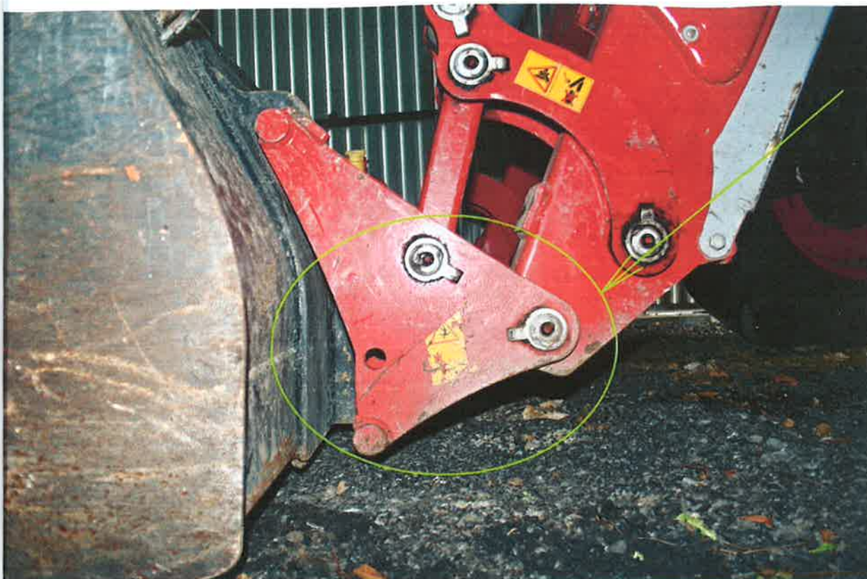
3. Pohled na čepy a otvory pro čepy nosíku nakládací lžice, které jsou vyosené.jpg 09.07.2020 13:19
